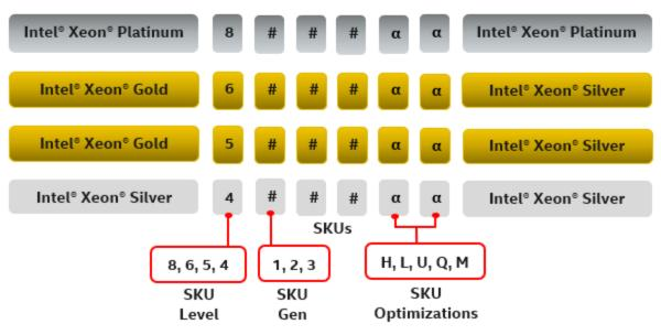
Figure 26. 3<sup>rd</sup> Gen Intel<sup>®</sup> Xeon<sup>®</sup> Scalable Processor Identification
