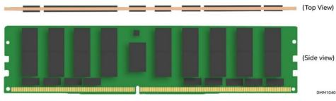
Figure 28. Standard SDRAM DDR4 DIMM Module
