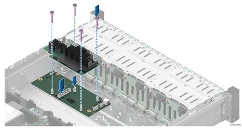
Figure 111. Intel<sup>®</sup> SAS RAID Module Placement
