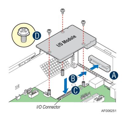
Figure 80. Intel<sup>®</sup> I/O Module Placement
