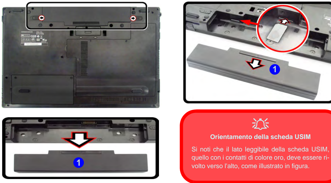
Figura 5 - Rimozione della batteria e inserimento della carta USIM
