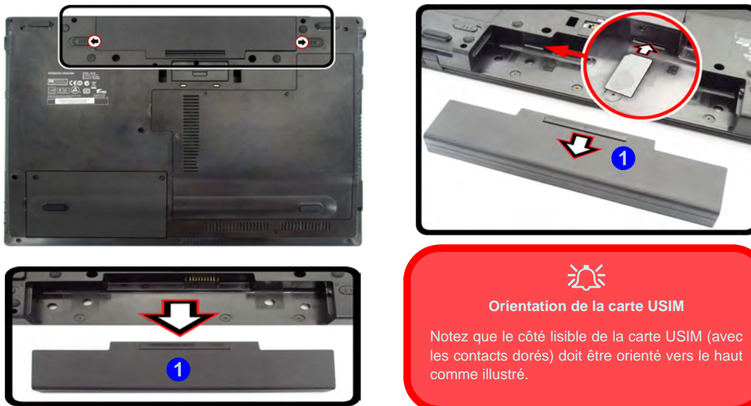
Figure 5 - Retirer la batterie et insérer la carte USIM
