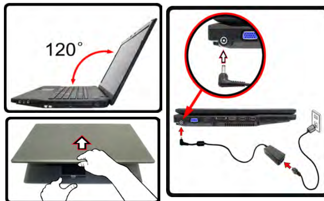
Figure 1 - Ouvrir le couvercle/LCD/ordinateur avec un adaptateur AC/DC branché
