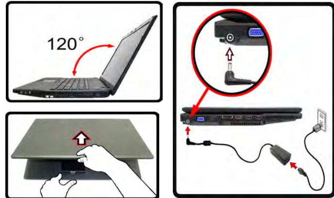
Abb. 1 - Öffnen des Deckels/LCD/Computers mit angeschlossenem AC/DC-Adapter
