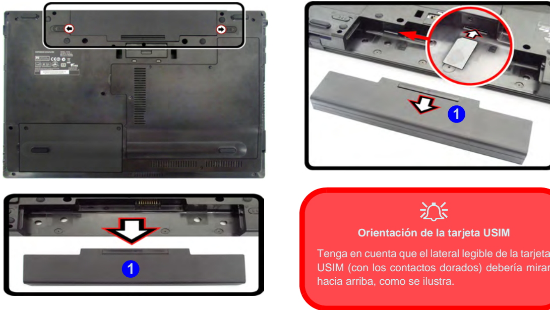
Figura 5 - Quitar la batería e insertar la tarjeta USIM
